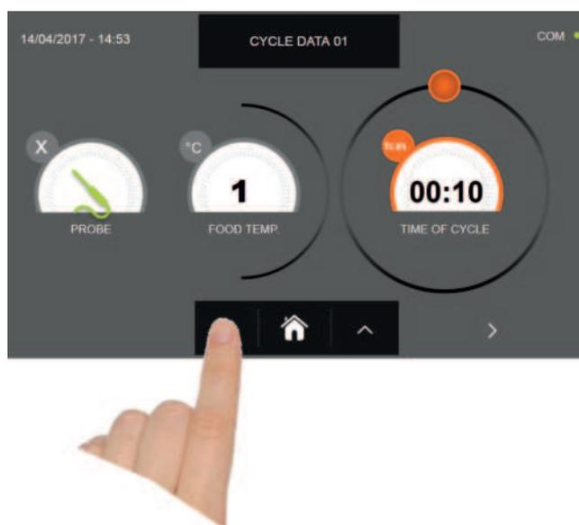
Pour régler les valeurs de température aliment et temps, utiliser les boutons
