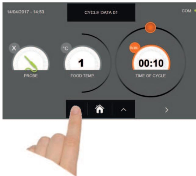
POUR régler les valeurs de température aliment et temps, utiliser les boutons
