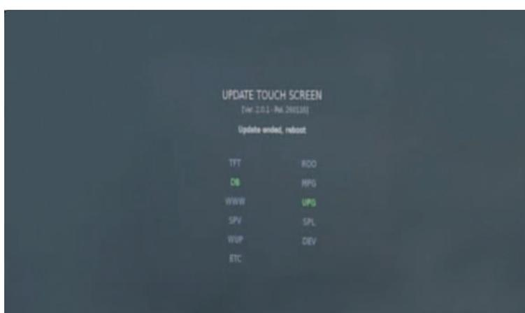
La procédure termine automatiquement et souligne en vert les fichiers correctement installés. La cellule de refroidissement rapide multifonctions s'éteindra et se rallumera automatiquement jusqu'à l'affichage de la page-écran d'accueil.
