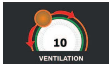
Le cycle s'achève dès qu'une température au cœur du produit supérieure ou égale à celle prédéfinie a été détectée. La fin du cycle est communiquée par un signal sonore. Appuyer sur l'écran pour arrêter la sonnerie. Autrement le signal sonore s'arrête automatiquement 60 secondes après. La machine passe en mode CONSERVATION à la fin du cycle.
